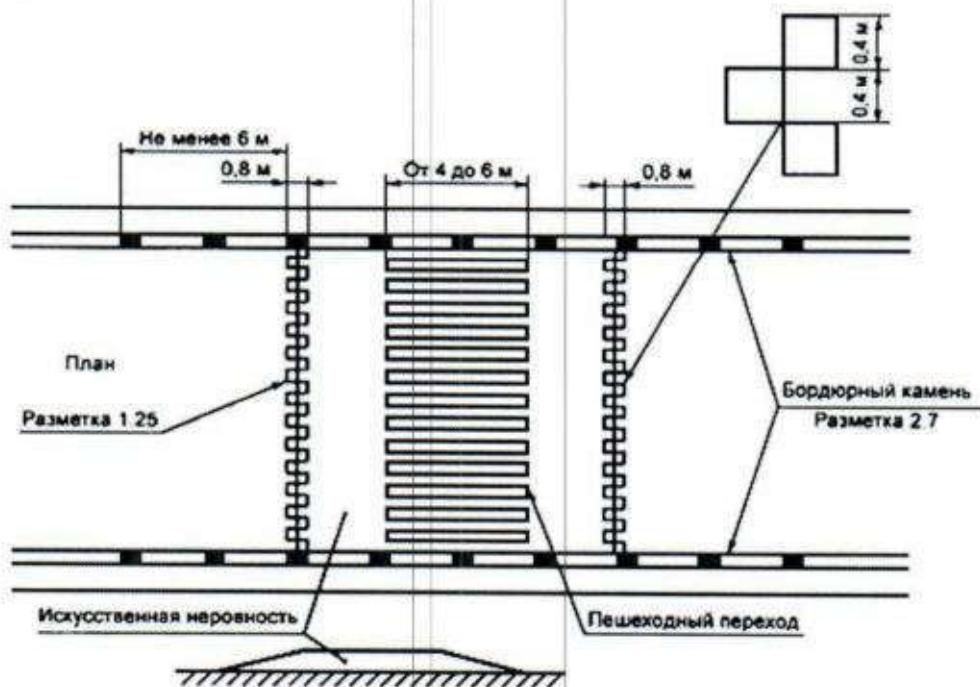
Рисунок 4 – Схематичный пример организации приподнятого пешеходного перехода
