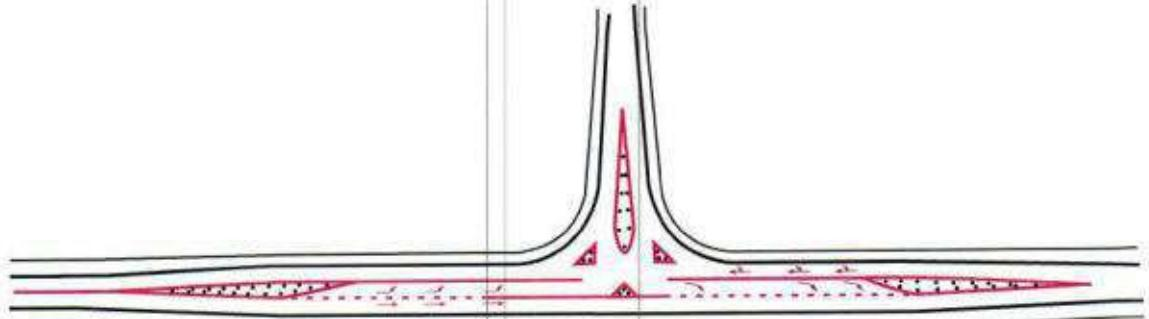
Рисунок 3 – Типовая схема организации канализированного движения на примыкании.
