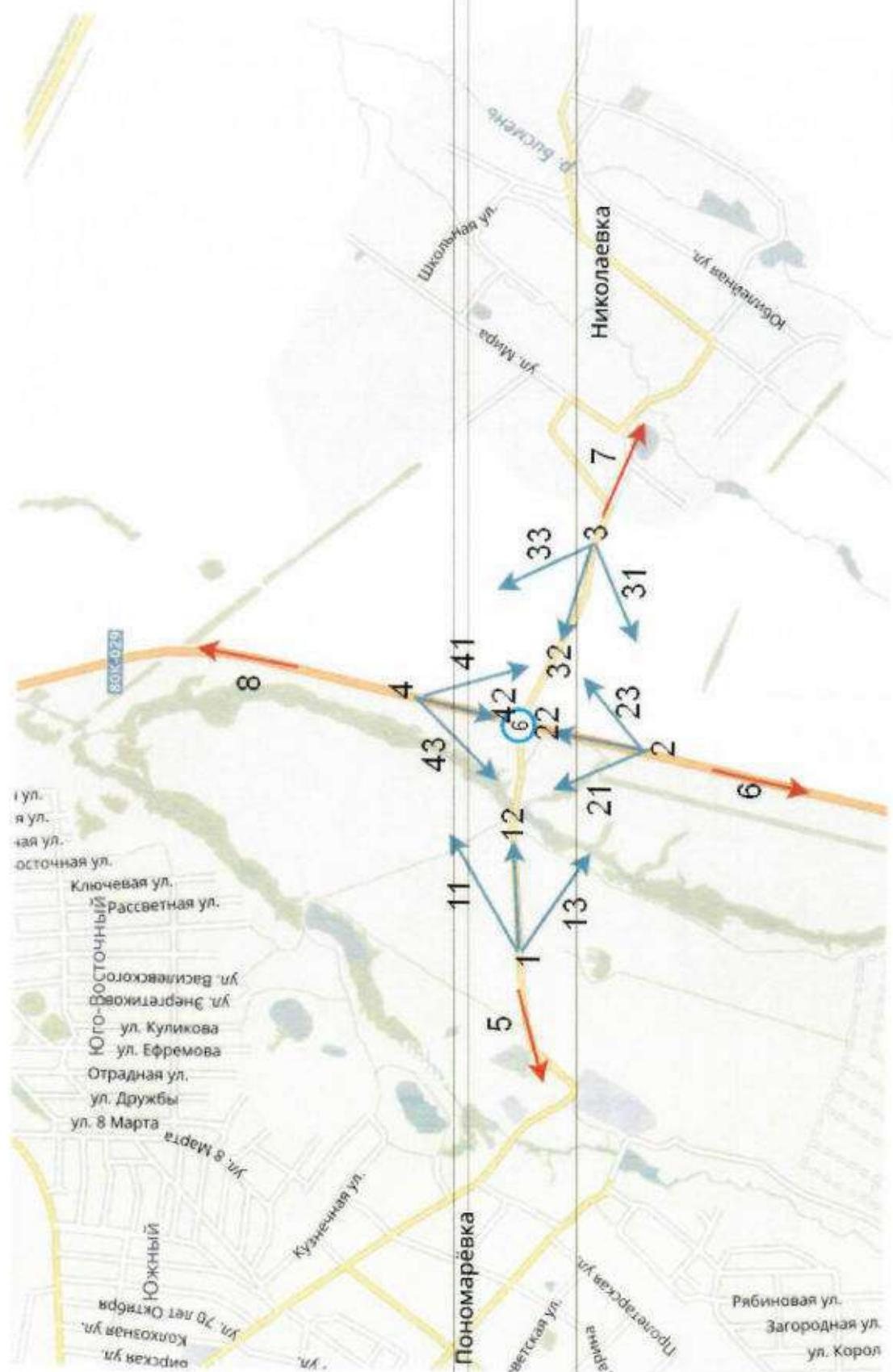
Рисунок А.5 – Схема движения транспортных средств на пересечении на пересечении а/д 80К-029 - Николаевская ул., г.Бирск, респ. Башкортостан
