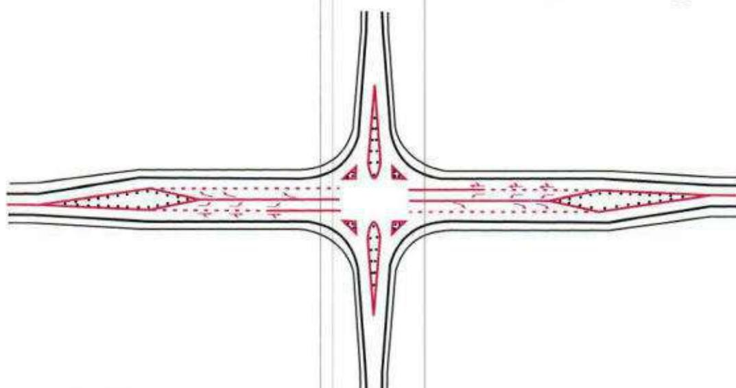
Рисунок 2 – Типовая схема организации канализированного движение на пересечении.
